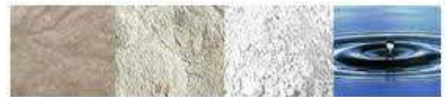
Arena de sílice + Cal + Cemento + Agua
